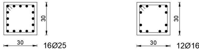
Figura 14. Comparación en las cuantías determinadas en la columna central
