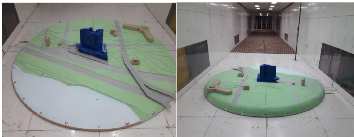
Figura 3. Emplazamiento del modelo y reproducción del entorno inmediato en la cámara de ensayos del túnel de viento.
