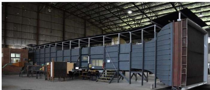
*Figura 2. Túnel de viento "Jacek P. Gorecki" de la UNNE.*
