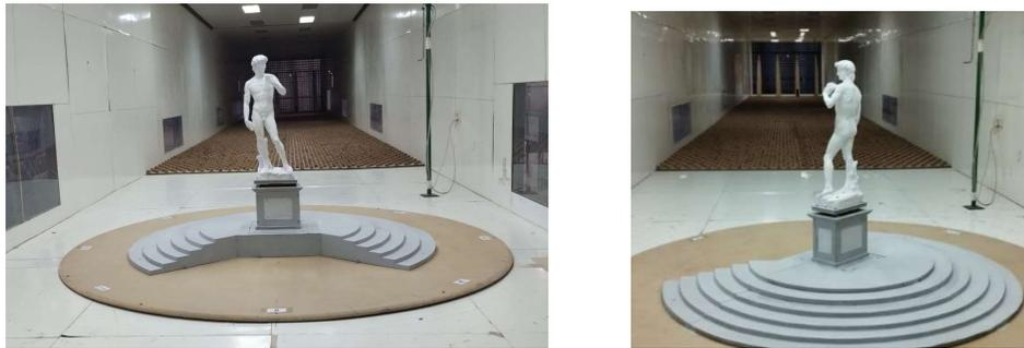
*Figura 5. Detalle del modelo de la escultura, estructura de emplazamiento y montaje en la cámara de ensayos del túnel de viento.*
