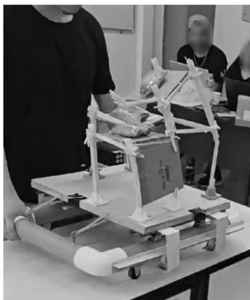
Figura 17. Ensayo de estructuras en el simulador sísmico portátil.
