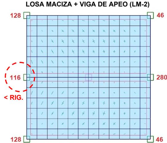
Figura 20b: Reacciones y flujos de cargas en los distintos tipos de sistemas con un apoyo rigidez reducida (análisis 2)
