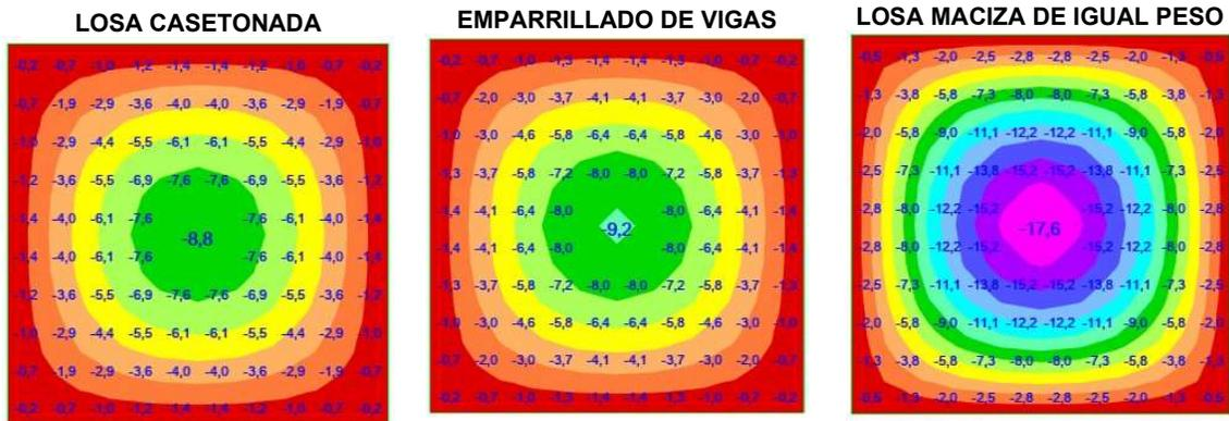
Figura 11b: Deformaciones obtenidas en los distintos tipos de losas -
