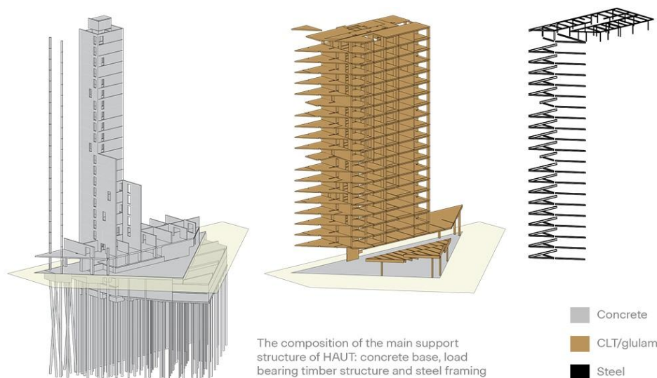
Figura 19: composición por materiales de la estructura.
