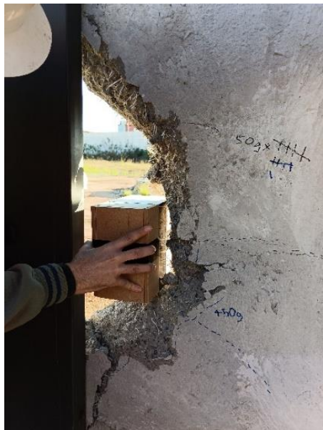
Figura 10. Ejemplo de apertura pasante tipo “forcible egress”
