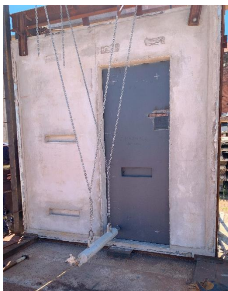
Figura 7. Ensayo de impacto horizontal sobre puerta
