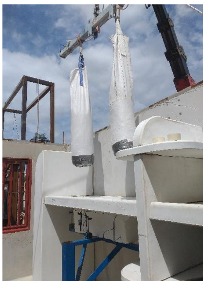
Figura 13. Disposición inicial de bolsas de impacto
