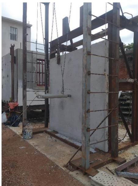
Figura 4. Ensayo de impacto sobre panel de pared
