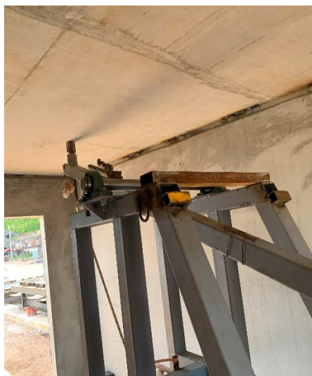
Figura 5: Ensayo de impacto sobre panel de techo
