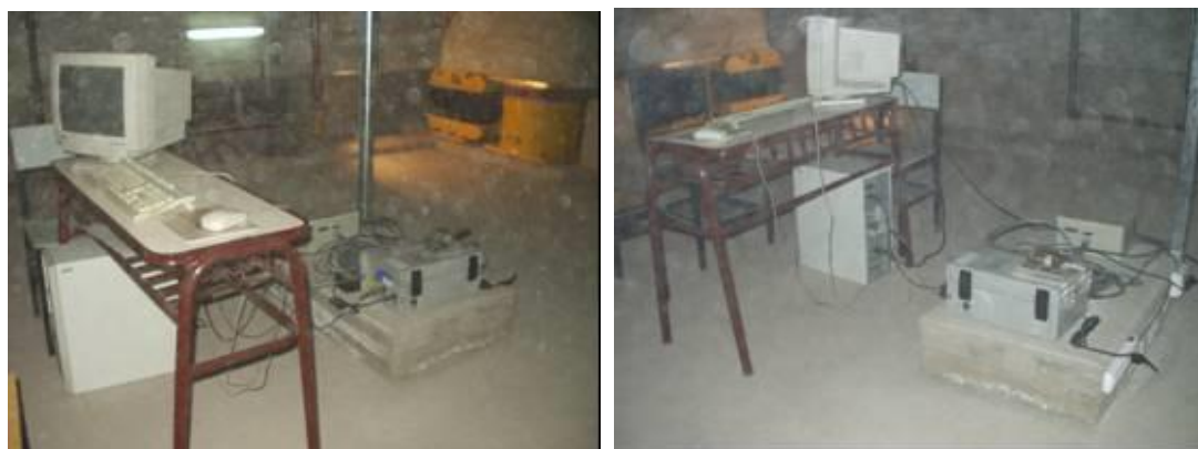
Figura 10. Central de adquisición de datos (Altus K2 de Kinematics – PC para comunicación y procesamiento de los registros sísmicos).
