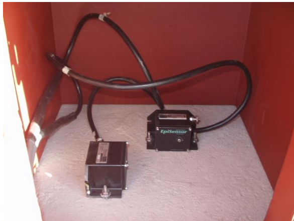
Figura 8: Coberturas metálicas de protección de los sensores externos.
