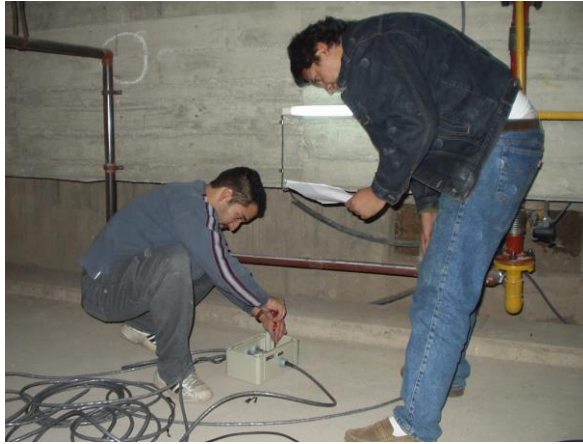
Figura 7: Tendido de cables y conexiones sensores externos. Central de adquisición de datos
