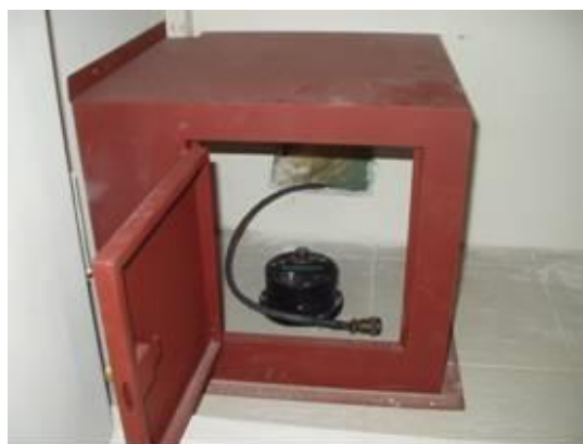
Figura 4. Sensores sísmicos instalados en puntos estratégicos de edificio aislado
