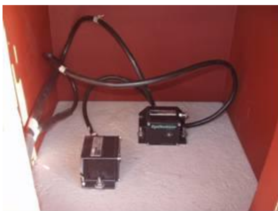
Figura 4. Sensores sísmicos instalados en puntos estratégicos de edificio aislado
