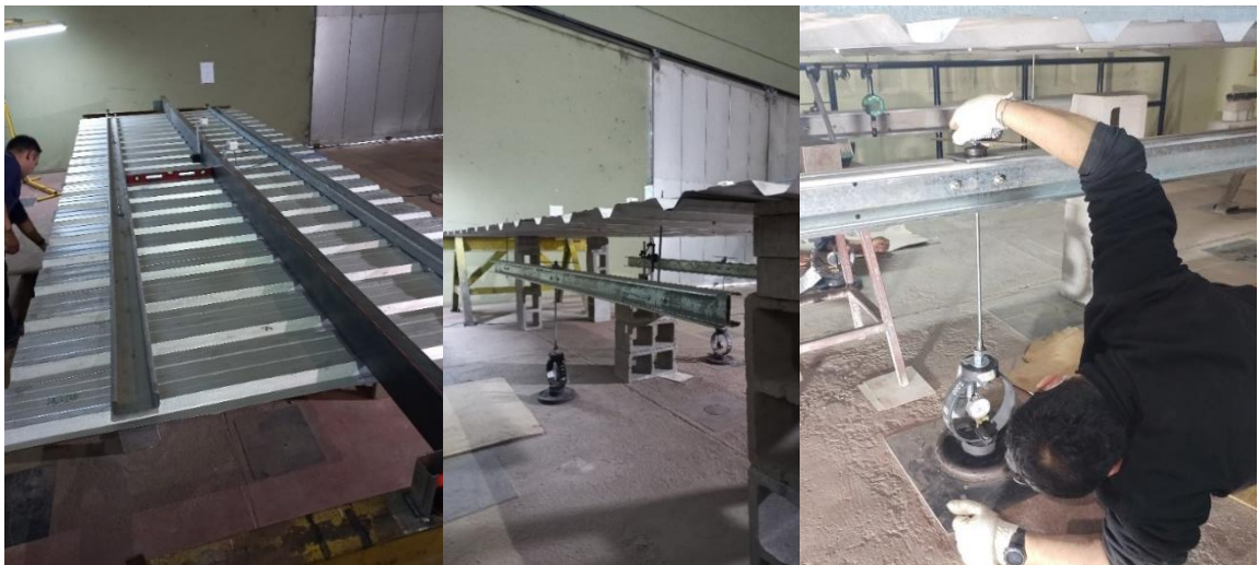
Figura 4. Imagen del proceso de carga a través de aros dinamométricos.
