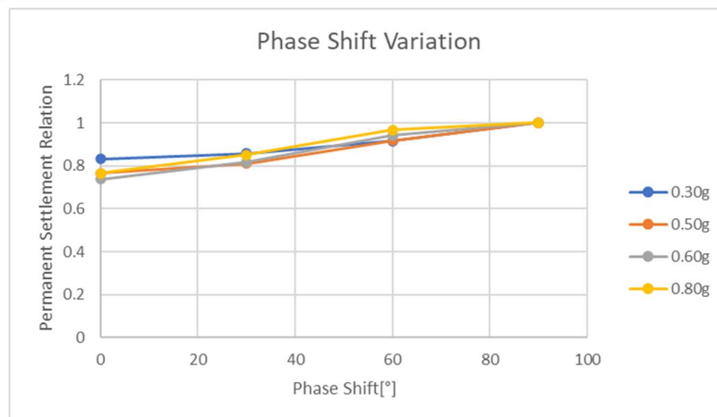
Figura 8 – Tendencia de variación del asentamiento permanente de cresta cuando se varía el ángulo de fase.
