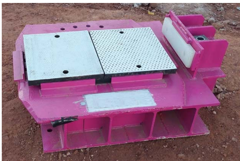
Figura 11. Dispositivo provisorio de apoyo deslizante provisto de guía lateral
