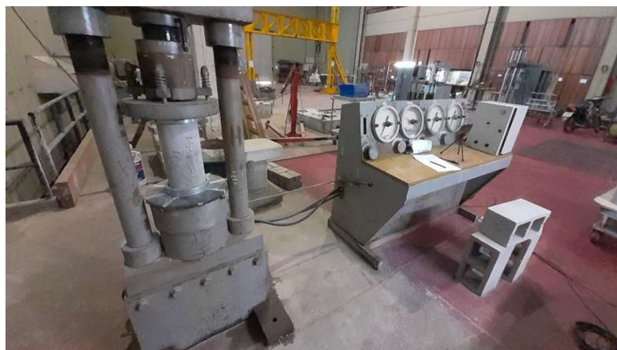
Figura 4. Equipo de compresión utilizado para realizar los ensayos.
