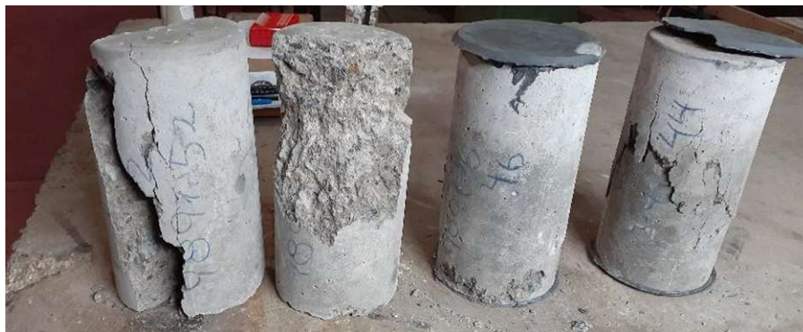
Figura 3. Vista de roturas de probetas típicas.
