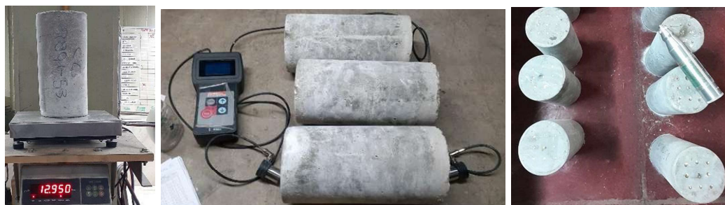
Figura 2. Ensayos de densidad, ultrasonido y esclerómetro.
