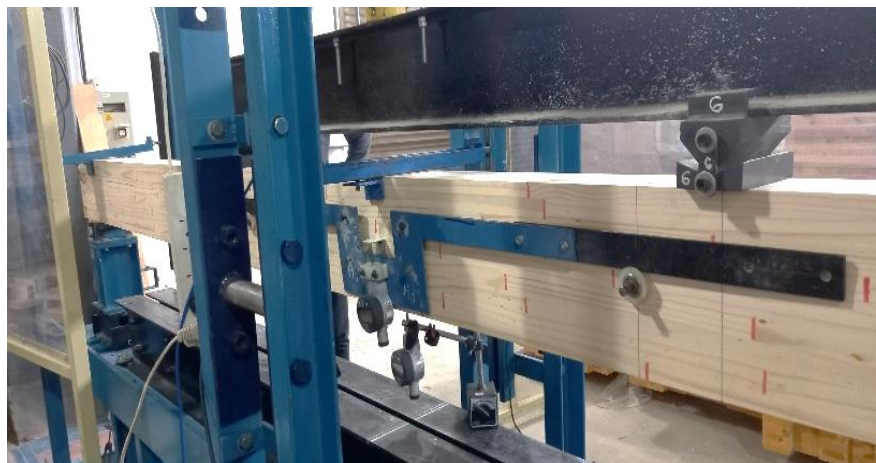
Figura 4. Dispositivo de medición de deformaciones en ensayo a flexión
