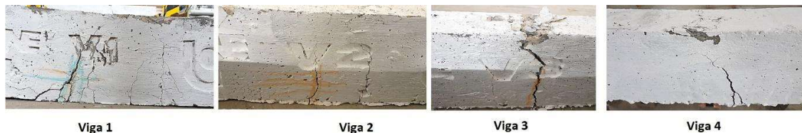
Figura 6. Fisuración de las vigas ensayadas.
