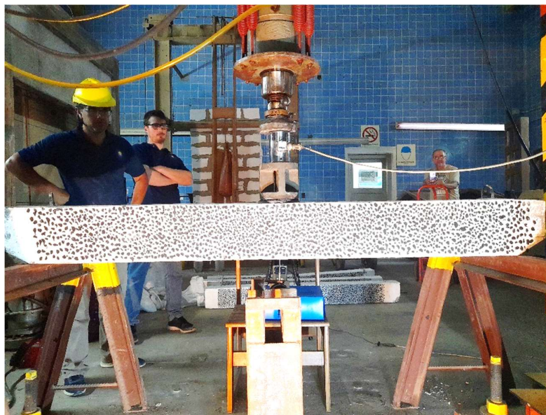
Figura 3. Configuración experimental del ensayo de flexión en tres puntos.
