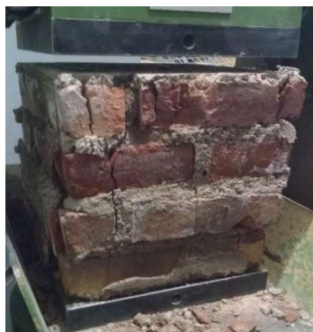
Figura 4: Vista frontal de la probeta luego de la rotura.
