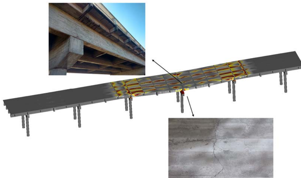
Figura 12. Tensiones principales de tracción compatibles con los patrones de fisuración observados en el puente
