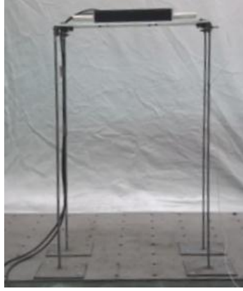
Figura 1. Estructura con sistema de control activo (AMD) [7] .
