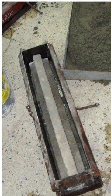
Figura 7. Molde metálico para probetas del ensayo de flexión. Disposición de vigueta en la parte inferior
