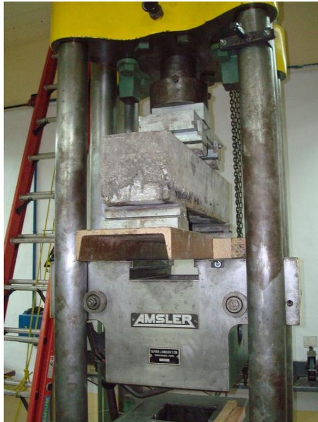
Figura 10. Probeta montada en prensa para antes del ensayo de carga
