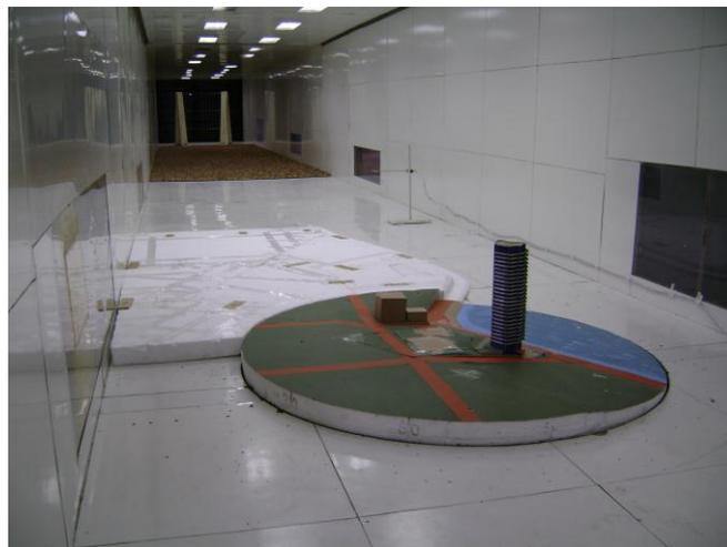
Figura 1. Simulación de viento natural en el túnel de viento.
