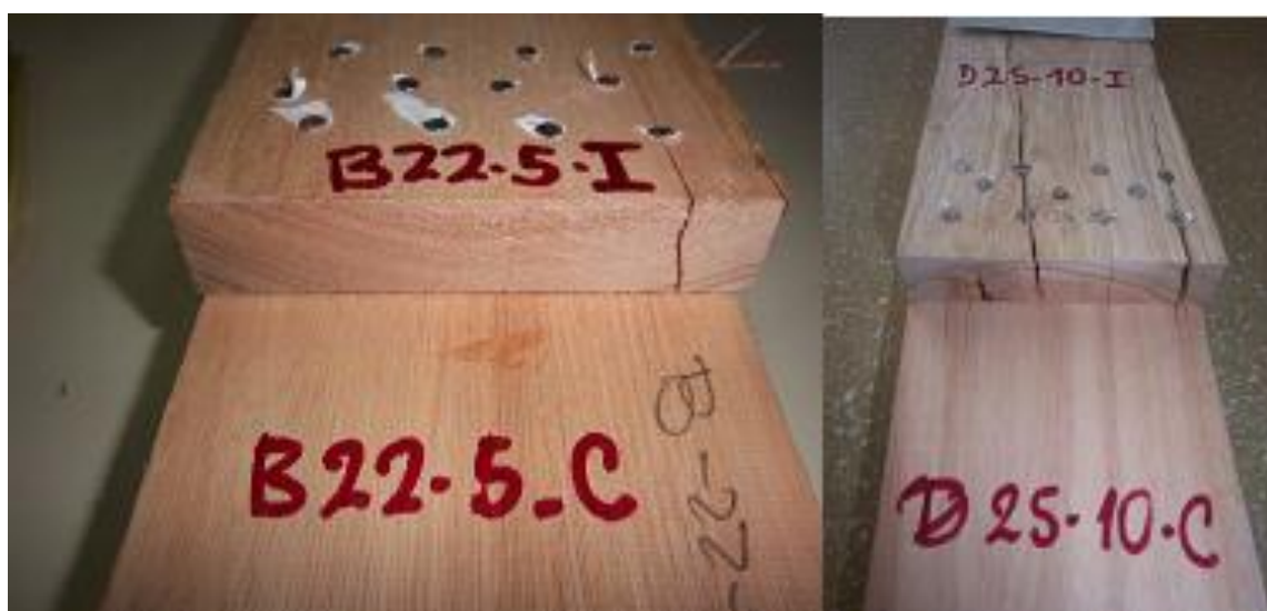
Figura 2: Cuerpos de prueba antes del ensayo mecánico, con fisuras debido al proceso de clavado.
