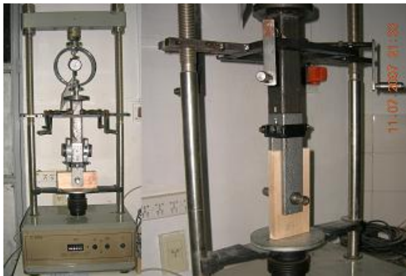
Figura 1: Dispositivos empleados para los ensayos: Máquina CONTROLS T400 y Máquina manual.
