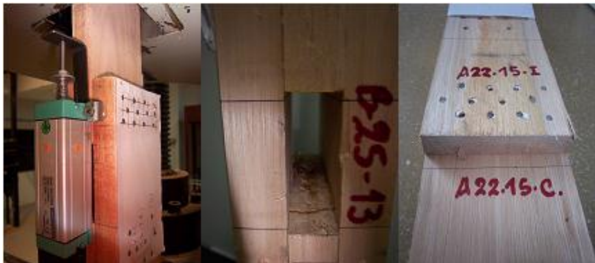
Figura 3- Esquema de armado y fotos de las probetas con uniones múltiples.
