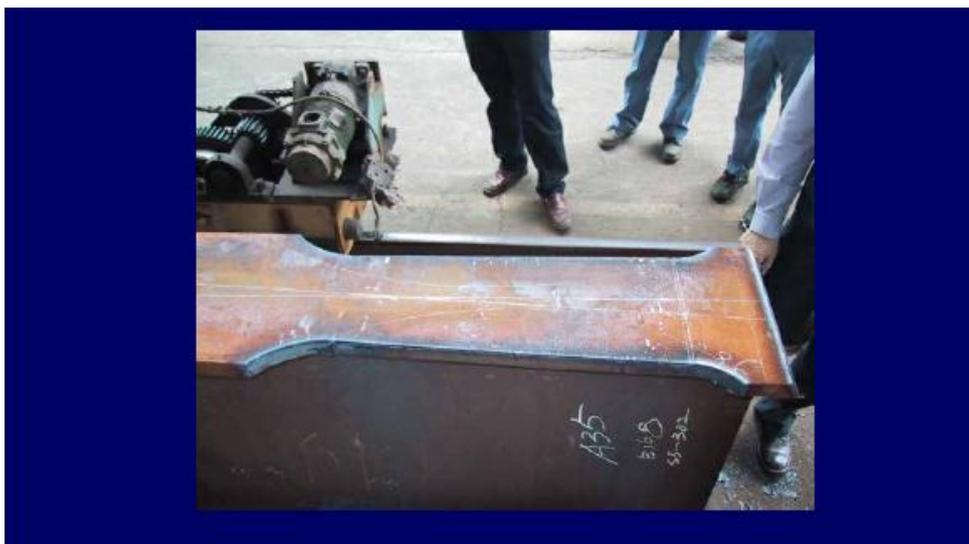
Figura 6.Viga con entalladura en sus alas
