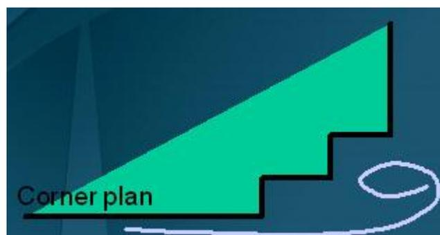
Figura 3. Detalle de escalonado de esquina, para atenuar vórtice.
