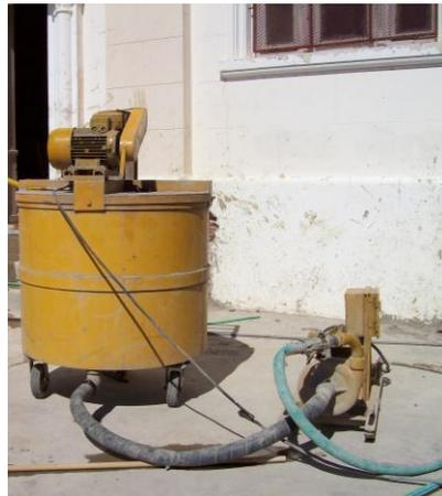
Figura 7: Equipo compacto para la elaboración de la lechada de cemento y posterior inyección a presión
