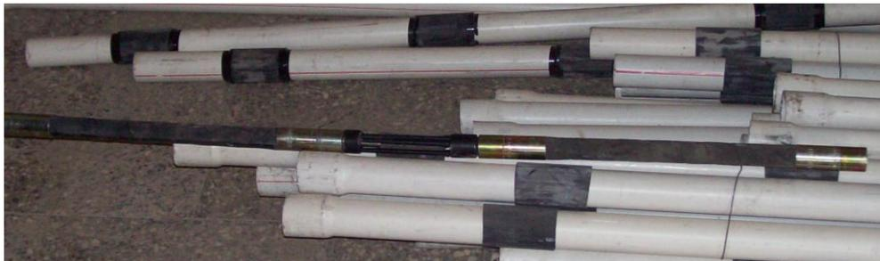
Figura 8: Obturador que permite la inyección secundaria
