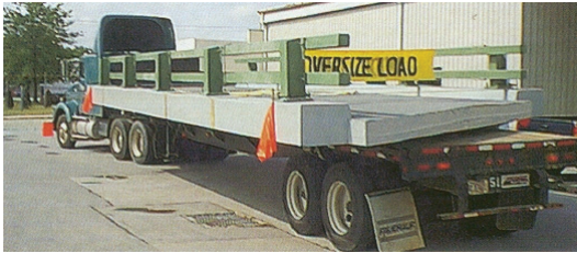
Figura 13: Transporte de um tabuleiro em FRP moldado manualmente híbrida [12].
