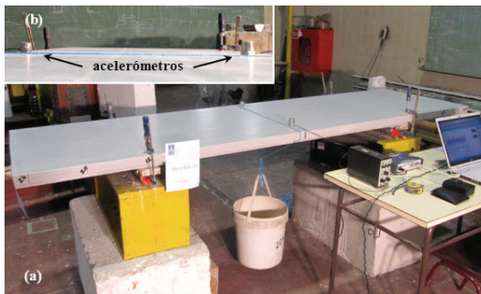
Figura 24: Ensaio dinâmico sob excitação induzida por peso de 20 kgf solto a meio vão.
