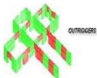
Fig. 25 Ejemplo del detalle de un cincho de rigidez para un edificio alto en Panamá, T = 8 s,
