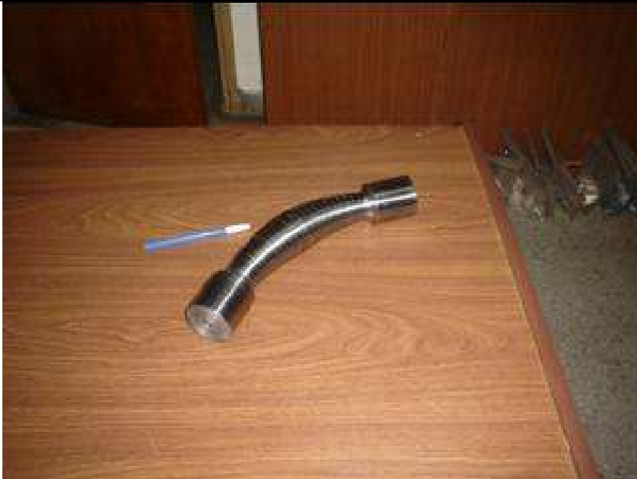
Fotografía N° 3 – Dissipador de energía a utilizarse en el Puente de Sorocayense de la Provincia de San Juan. Se observan dos dissipadores unidos por la base, a los efectos de realizar uno de los ensayos.
