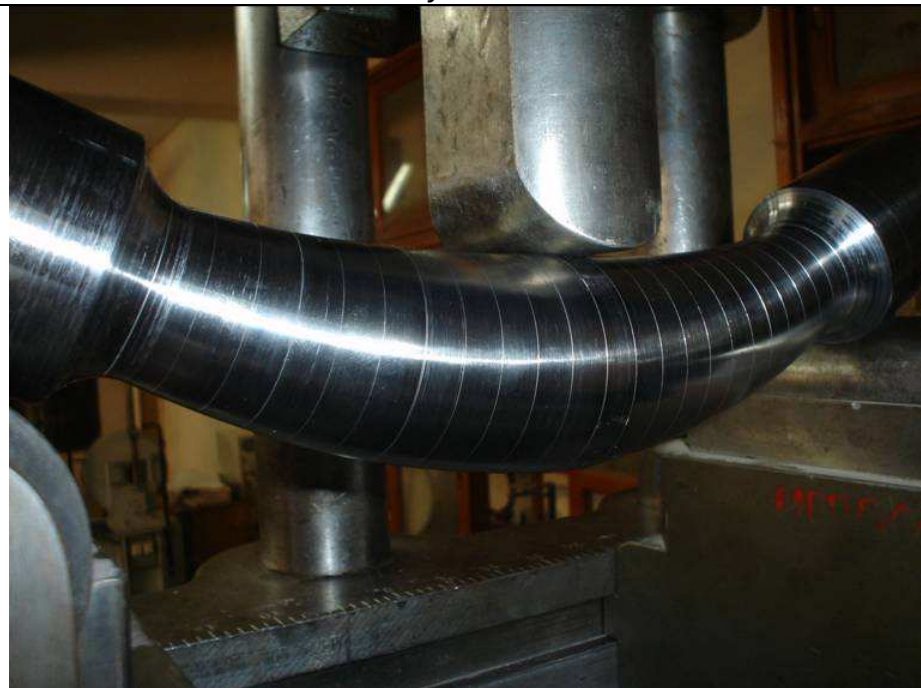
Fotografía N° 4 – Ensayo de los dissipadores de Energía. Se observan divisiones igualmente espaciadas antes y después de la deformación.
