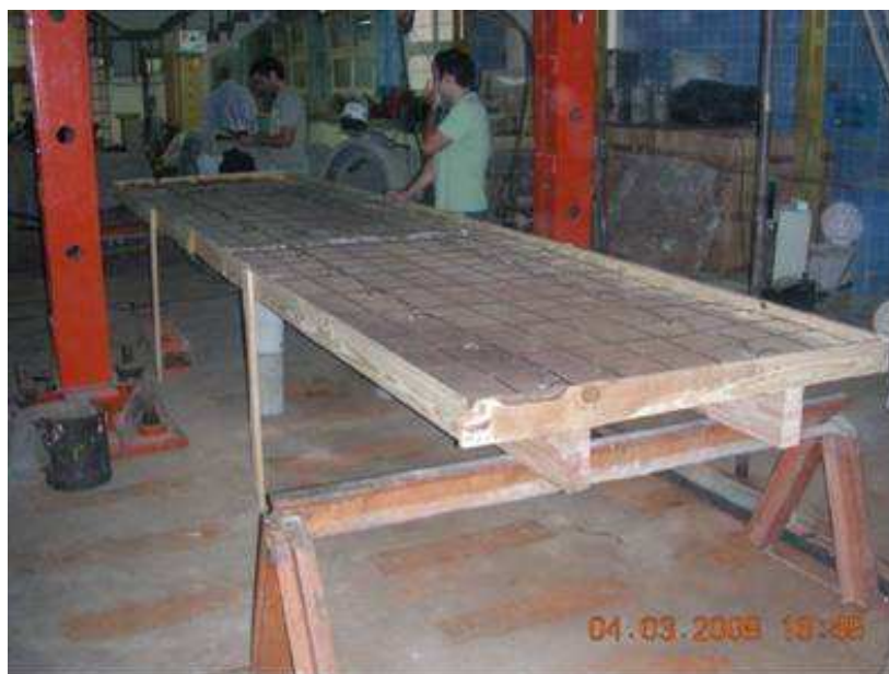
Figura 10: Prototipo de Ensayo a la Flexión
