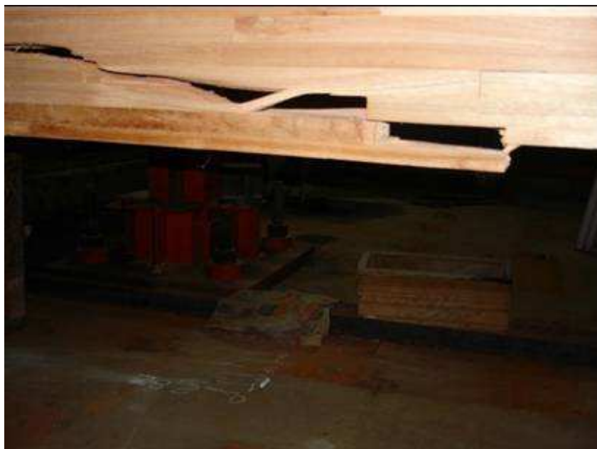
Figura 16: Rotura a Flexión
