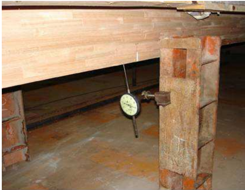
Figura 14: Flexímetro para medir deflexión máxima
