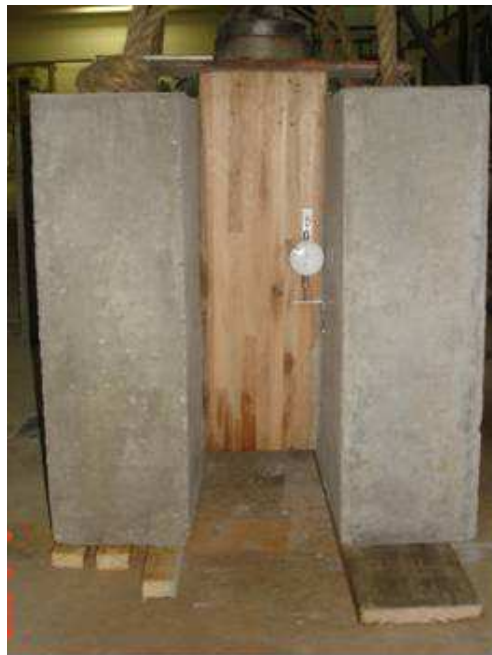
Figura 3: Esquema ubicación del extensímetro.
