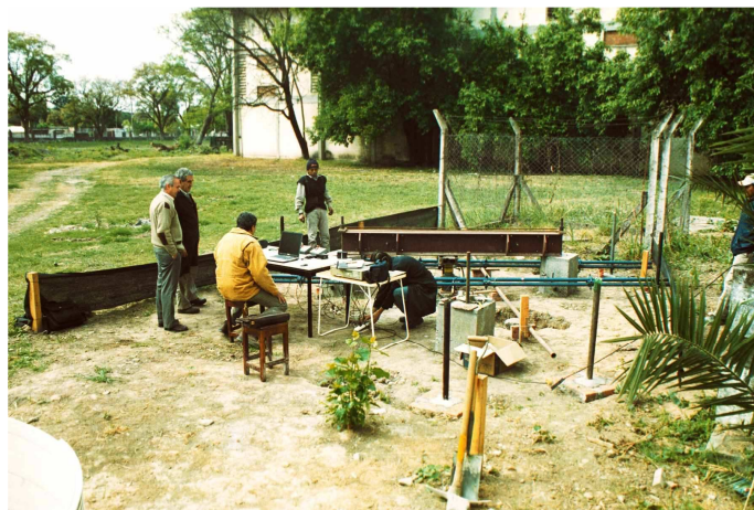
Figura Foto 5.1: Banco de carga de 6 micropilotes (tracción, 3; compresión 3)
