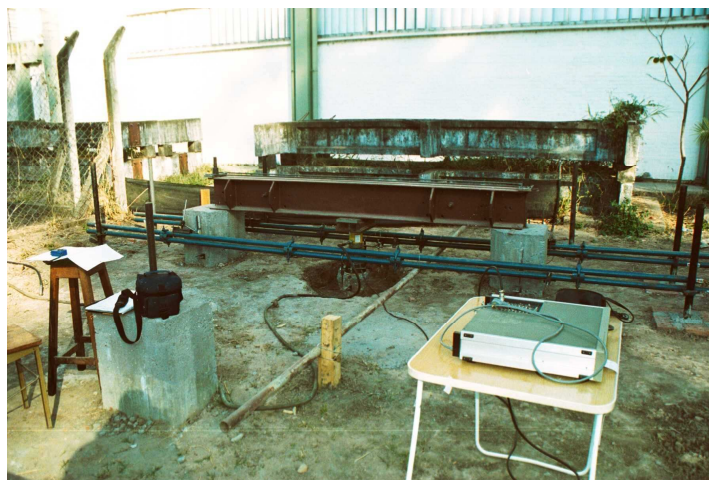
Figura Foto 5.2: Ensayo de carga de micropilote 1, testigo.
