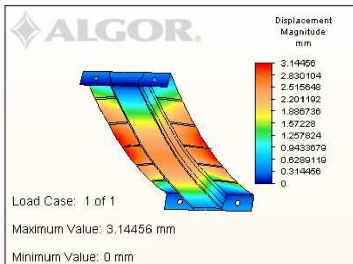
Figura 16. Deflexión típica M04 (SC y CC), M06 (SC y CC), dirección Y.
