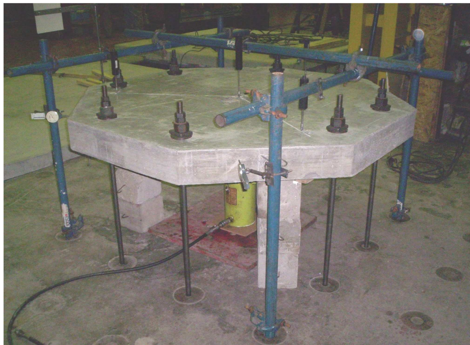
Figura 9 – Vista del prototipo y dispositivos de carga, apoyo y medición
