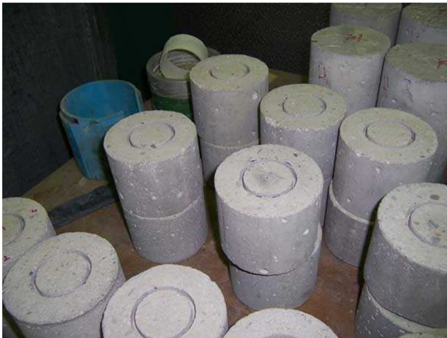
Figura 1. Muestras cortadas, pulidas y entalladas
