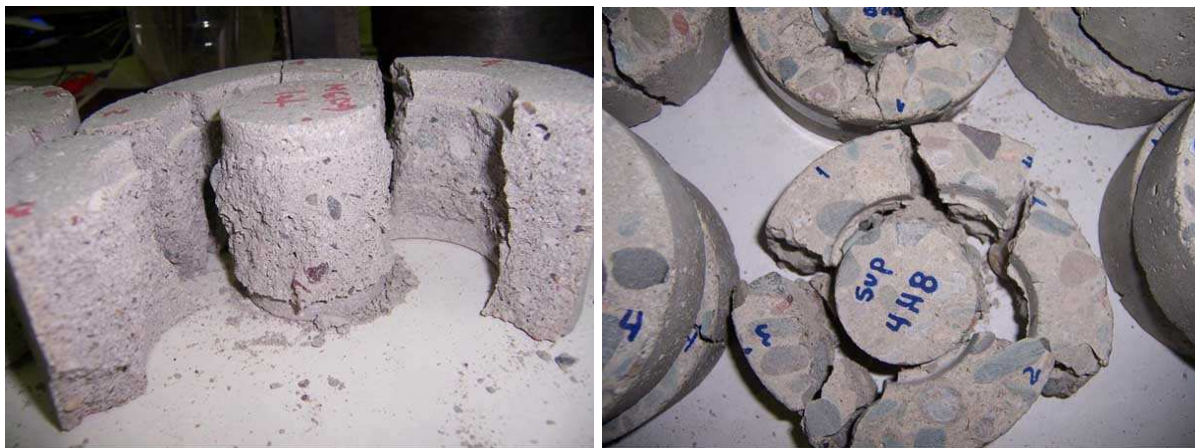
Figura 6. Fisuración en muestras ensayadas
