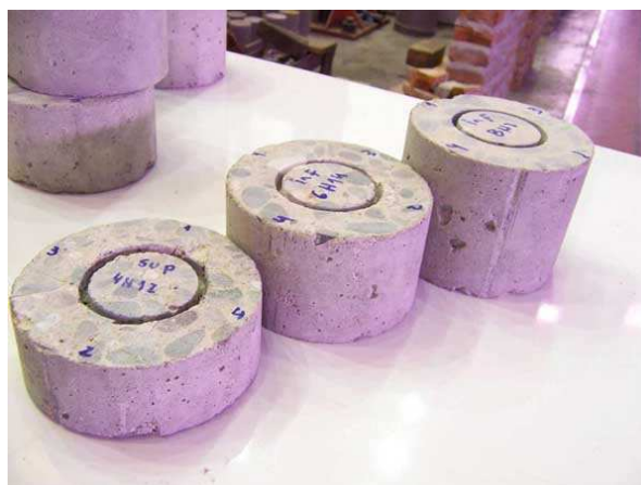
Figura 5. Probetas tipo LUONG antes de ensayarse
