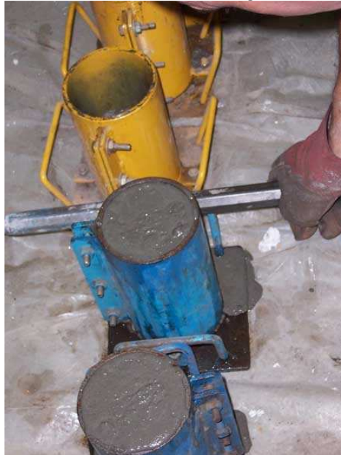
Figura 4 moldeado de probetas
