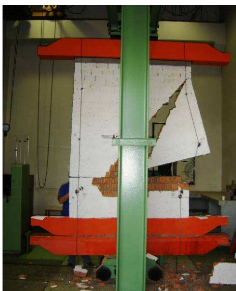
Figura 14 – Parede com blocos cerâmicos estruturais de 12 furos: base rígida
