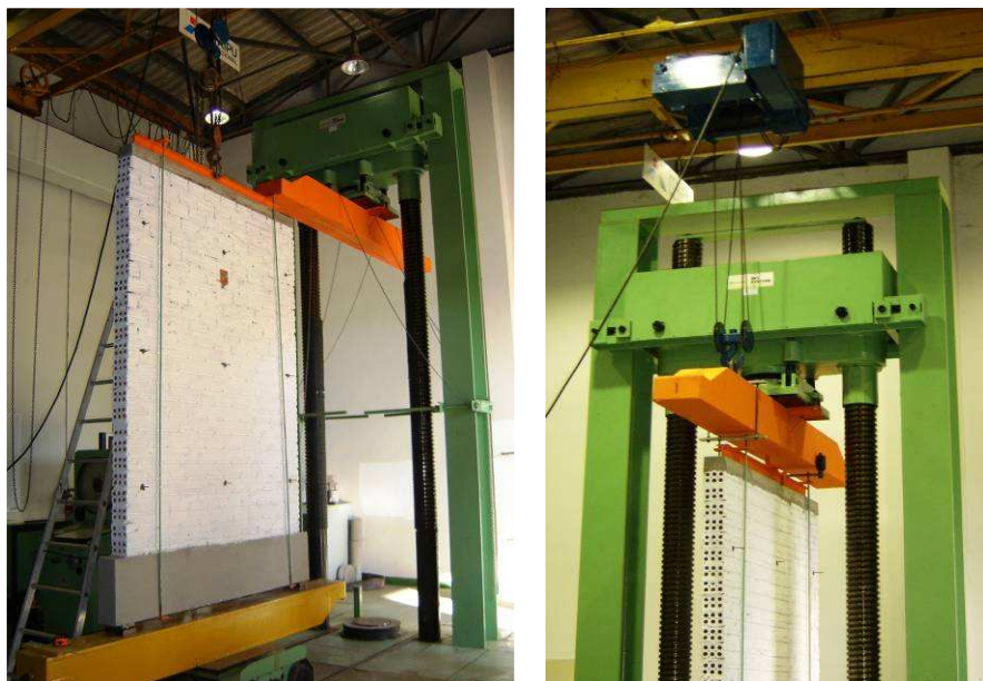
Figura 6 – Posicionamento da parede na prensa hidráulica
