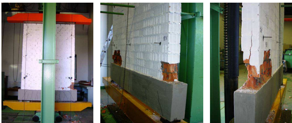
Figura 17 – Parede com blocos cerâmicos estruturais de 12 furos - base elástica
