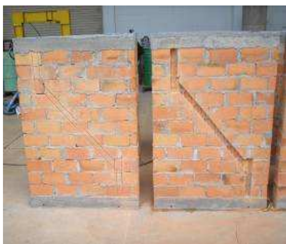
Figura 4 – Corte das paredes, e profundidade de corte (cm)
