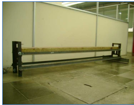
Figura 11. Configuración experimental para realizar saltos de vibración forzada en laboratorio.
