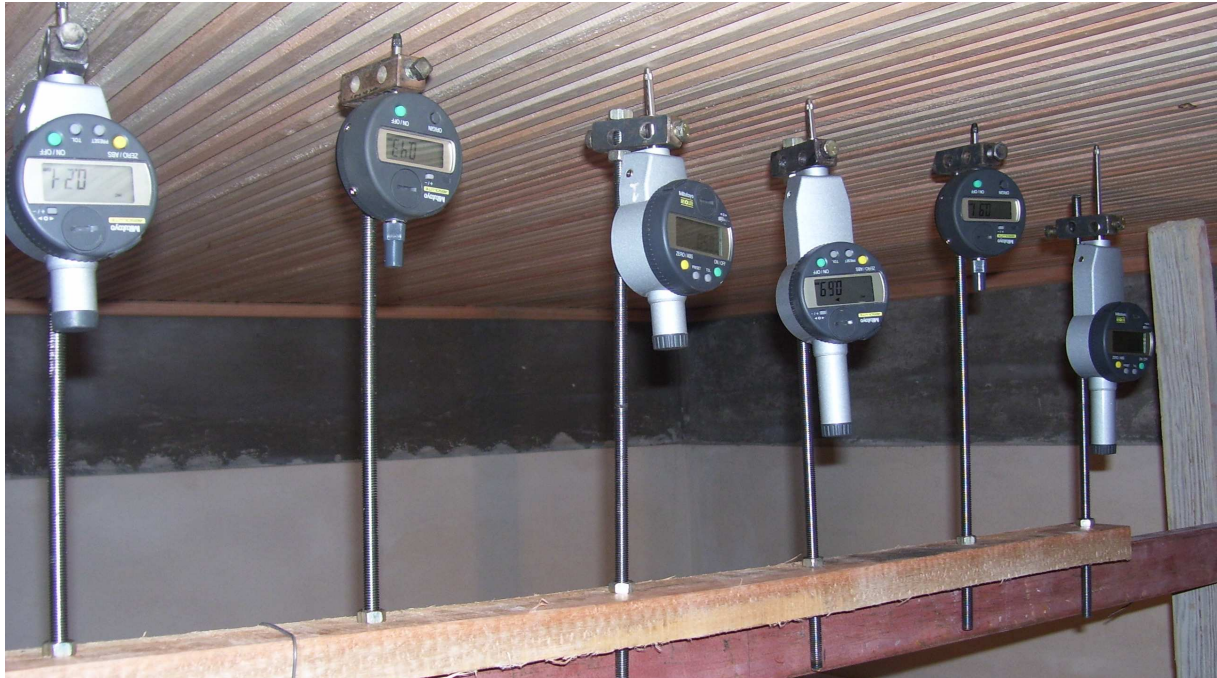
Figura 3: Ubicación de los extensómetros para registrar las deformaciones durante el ensayo de carga.
