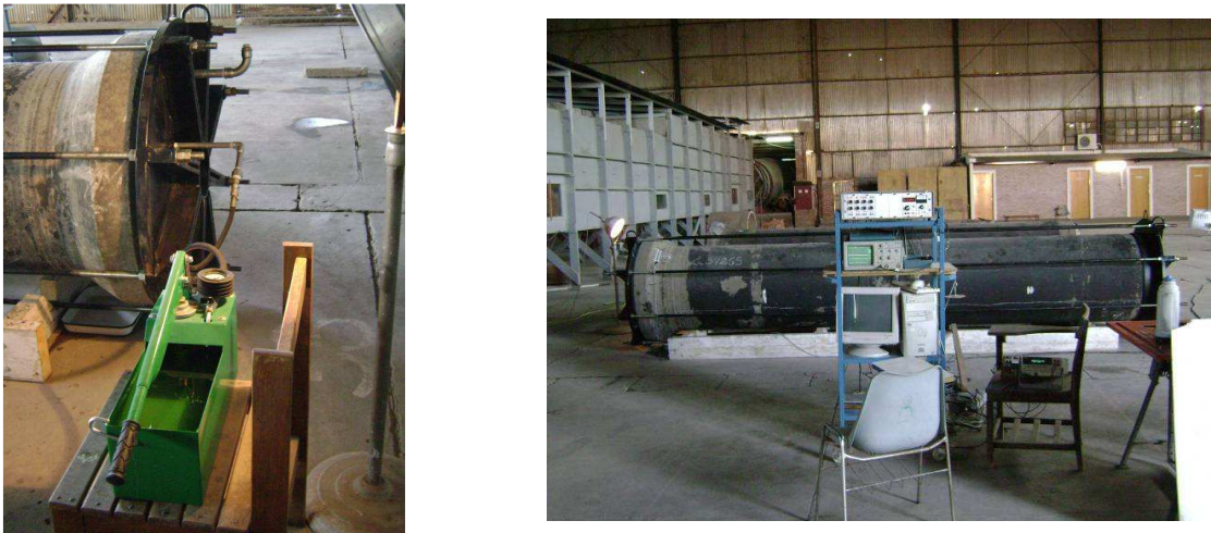
Figura 5: Esquema de la bomba de presión y el montaje del dispositivo de ensayo completo.
