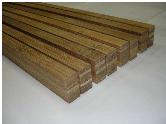
Figura 5 – Vigas de Bambu Laminado Colado com 7 lâminas de 7,3 mm
