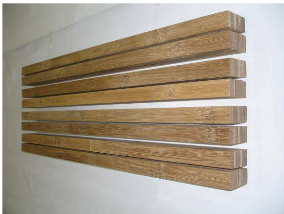
Figura 5 – Vigas de Bambu Laminado Colado com 7 lâminas de 7,3 mm
