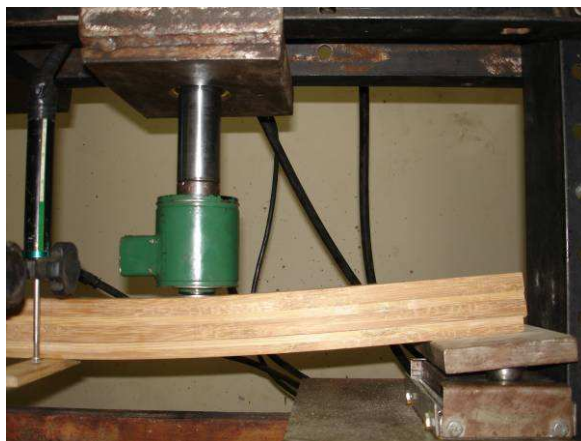
Figura 6 – Vigas de Bambu Laminado Colado: ensaio de flexão
