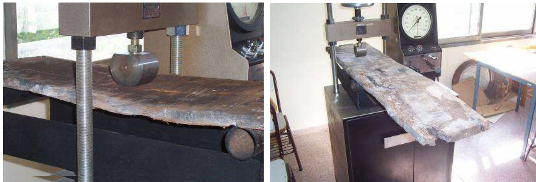
Fig. 17 – Ensayo a Flexión del tablón
