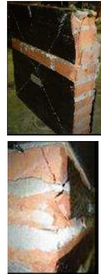
Figura 2 – Curvas carga-desplazamiento axial y transversal totales de paneles reforzados con PRFC. Comparación con especímenes no reforzados. Tipos de rotura.
