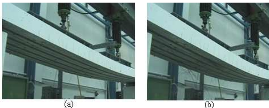
Figura 11 – Viga VFC_PE_02: Durante o ensaio; (b) Após a ruptura do reforço por esgotamento da capacidade resistente do laminado de fibra de carbono.
