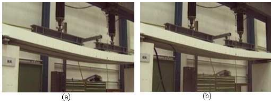
Figura 10 – Viga VFC_NP_01: (a) Durante o ensaio; (b) Após a ruptura prematura do reforço.
