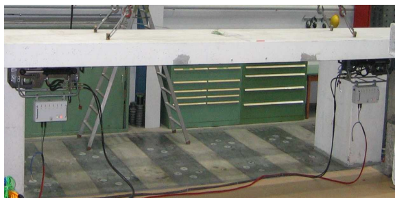
Figura 3 – Nova versão do equipamento de protensão desenvolvido por Stoecklin & Meier 6 .
