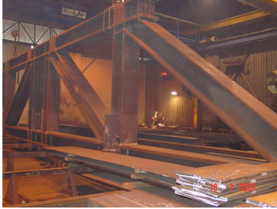
Fig. 14: Reticulado Pratt con junta horizontal en el taller (montado temporalmente y alineado para detallado de las juntas). Detalle de juntas abulonadas.
