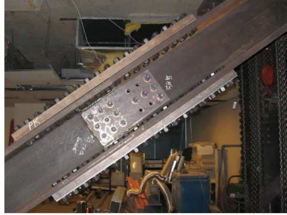
Fig. 14: Reticulado Pratt con junta horizontal en el taller (montado temporalmente y alineado para detallado de las juntas). Detalle de juntas abulonadas.
