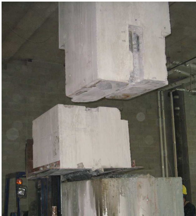
Fig. 28: Remoción del primer pedazo de la columna.
